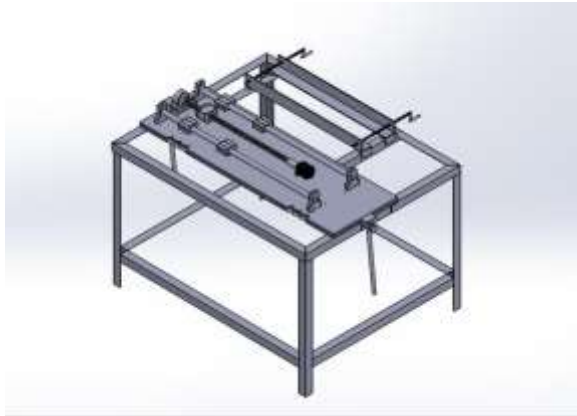
Gambar 2. Desain wujud dari holder torch dan mekanisme pergerakan sumbu X dan Y
