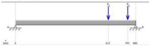
Gambar 4 Keadaan pembebanan pada poros lintasan atau slideway dititik kiri
