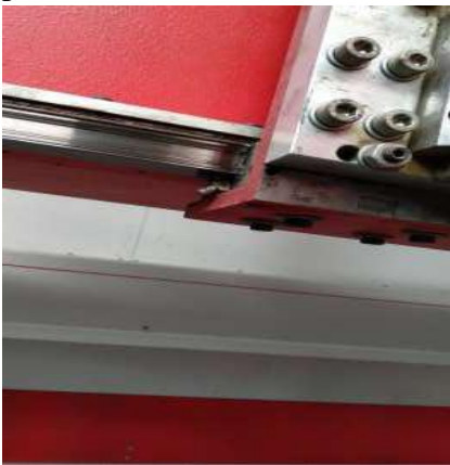
Gambar 2. tempat pengisi pelumas rail axis (Sumber: CV Laksana )
