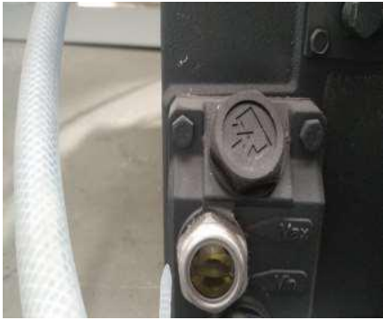
Gambar 4. kaca kontrol ketinggian oli vakum (Sumber: CV Laksana )
