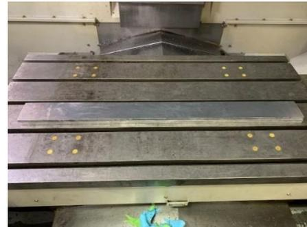
Gambar 11. Pemasangan Benda Kerja
