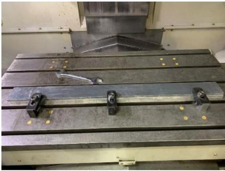
Gambar 12. Pemasangan Klem pada Benda Kerja
