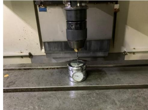
Gambar 15. *Setting ketinggian tool dengan alat Zero Setter*
