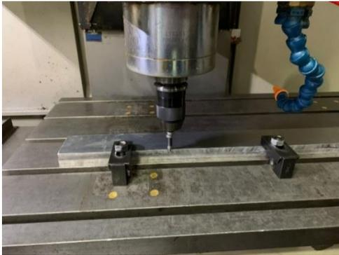
Gambar 14. *Setting workplane X0 dan Y0 menggunakan centrofix*
