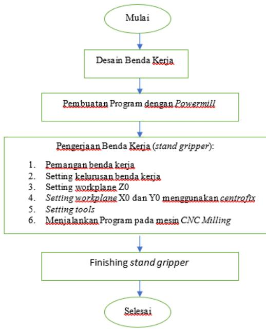
Gambar 2. Diagram alir proses produksi stand gripper dengan CNC Milling 3 AXIS
