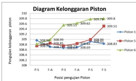
Gambar 6 Diagram pengujian pada piston memiliki power 2100, jam putaran 12000, standar 310 mm  $\pm$  dan limitnya 1,5 mm
