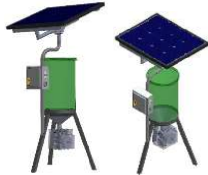
Gambar 2. Desain Alat Penebar Pakan Ikan Otomatis
