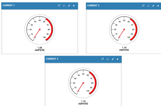
Gambar 9. Tampilan antar muka hasil pengukuran arus pada web ThingSpeak
