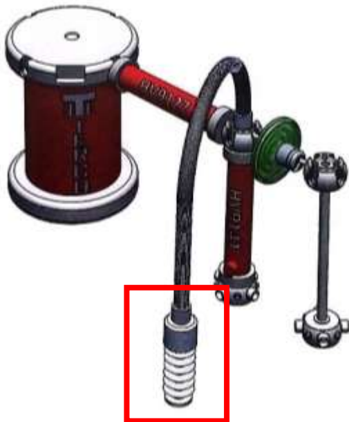
Gambar 4. Rangkaian Uji Tegangan Flashover
