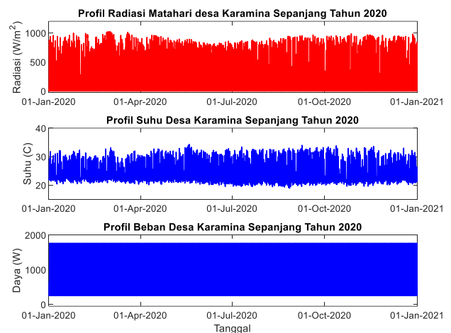
Gambar 3. Profil radiasi matahari, suhu dan beban Desa Karamina sepanjang tahun 2020
