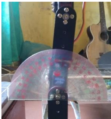
Gambar 5. Gambar Pengujian Output Sudut Motor Servo
