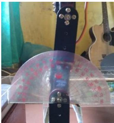
Gambar 5. Gambar Pengujian Output Sudut Motor Servo
