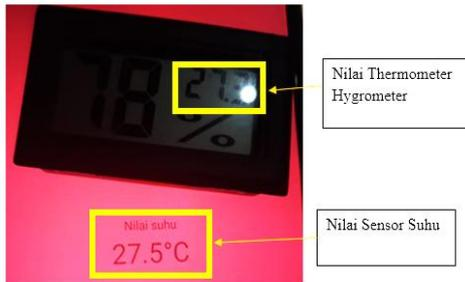
Gambar 8. Proses Pengujian Kalibrasi sensor Suhu
