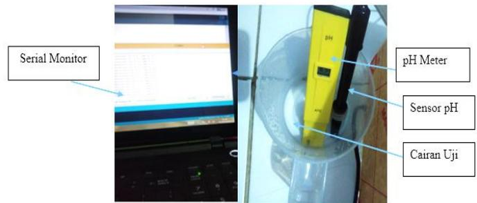
Gambar 7. Pengujian Kalibrasi sensor pH
