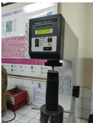
Gambar 3. Alat uji kekerasan *Rockwell*
