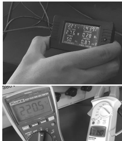
Gambar 4. Perbandingan Hasil Pengukuran Sensor PZEM-004T dengan Multimeter
