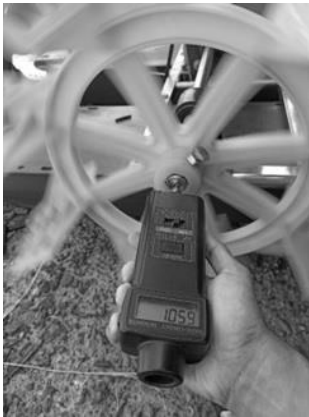
Gambar 5. Proses Pengujian Performansi Motor Kincir Aerasi menggunakan Tachometer
