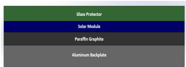
Gambar 3. Pandangan depan lapisan-lapisan panel surya dengan PCM sebagai pendingin
