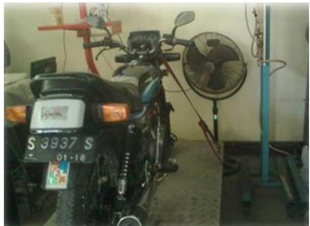
Gambar 1. Proses pengujian kendaraan dengan dynotest
