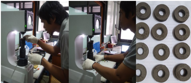
Gambar 3. Proses Pengambilan Data Kekerasan Menggunakan Rockwell Hardness Tester
