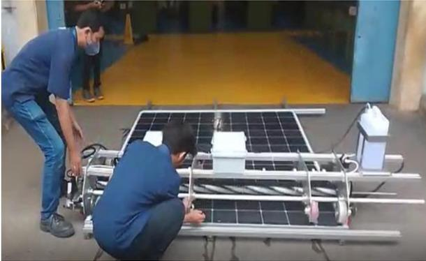
Gambar 10. Pengujian Fisik Robot *Solar PV Cleaner*
