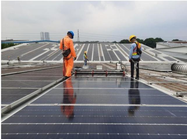
Gambar 2. Pengujian *prototype* pertama robot *solar cleaner*
