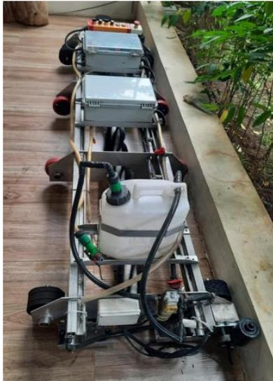
Gambar 5. Bentuk *Prototype* robot *cleaner* pertama
