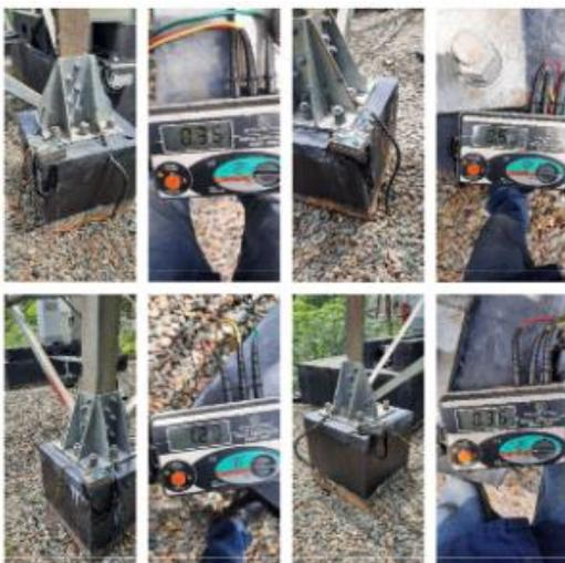
Gambar 9. Pengukuran Tahanan Pembumian (Grounding)
