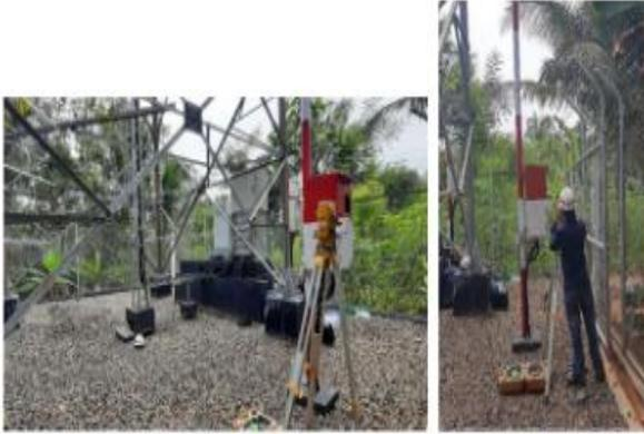
Gambar 8. Pengujian Kemiringan Tower
