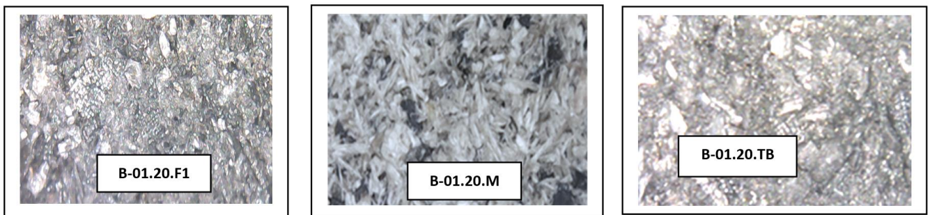
Gambar 16. Kondisi susunan partikel melalui foto morfologi, 3 specimen dengan nilai kalori diatas 3500 kcal/kg (perbesaran 20X)
