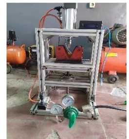
Gambar 4. (a). Set up eksperimen Pengeringan, (b). Metode press pellet jumpatan padat (1), Piston, (2), Pencetak pellet, (3). Pellet BBJP, dengan kompresi dengan pneumatic
