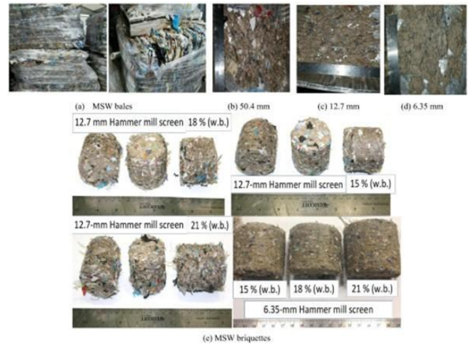
Gambar 1. Bentuk bahan bakar jumputan padat /pellet co firing dengan variasi dimensi pencacahan, sesuai SNI 8966:2021, dengan campuran plastik 20% [5], [6].
