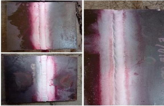
Gambar 4. Hasil uji dye penetrant pada capping
