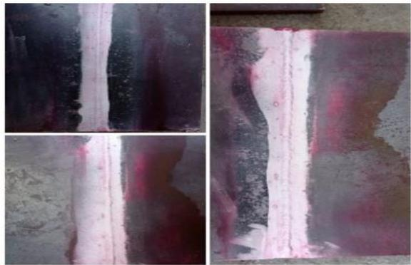
Gambar 5. Hasil uji dye penetrant pada root
