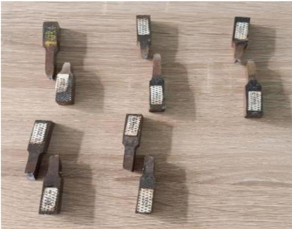
Gambar 9. Spesimen hasil pengujian tarik
