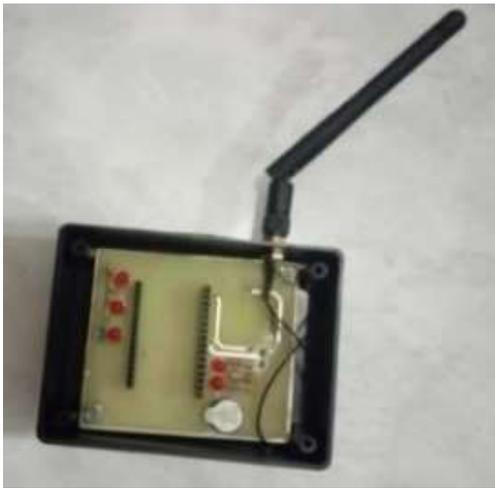
Gambar 15. Tampak Dalam Rangkaian Gateway
