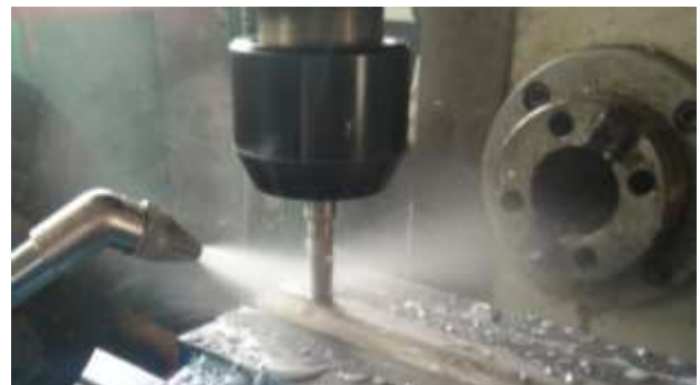
Gambar 7. Proses pengerjaan menggunakan media pendingin dromus
