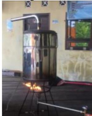
**Gambar 3.** Proses Pembakaran Batang Bambu Kuning Dengan Metode Pirolisis
