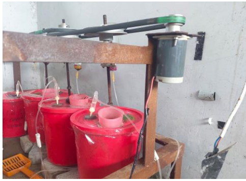
Gambar-1. Reaktor POC
