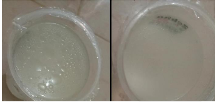
Gambar-7. Kondisi limbah cair bekas cucian piring sebelum dan sesudah proses pengolahan melalui grease trap
