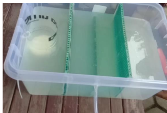
Gambar-5. Kondisi padatan yang tertahan oleh saringan di ruang I
