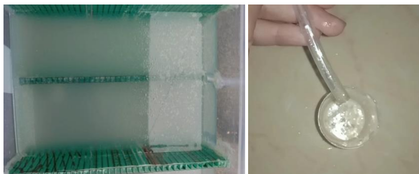
Gambar-6. Kondisi limbah cair di ruang II dan minyak yang keluar dari ruang II
