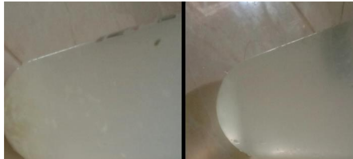
Gambar-5. Kondisi limbah cair dapur sebelum dan sesudah treatment
