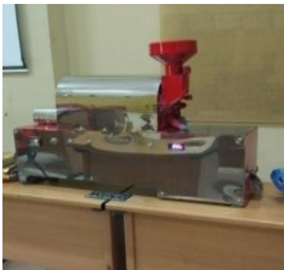
Gambar 6. Mesin Penyangrair Kopi Kapasitas 1 Kg dengan Pengatur Suhu dan Waktu menggunakan Termostat REX-C 100.
